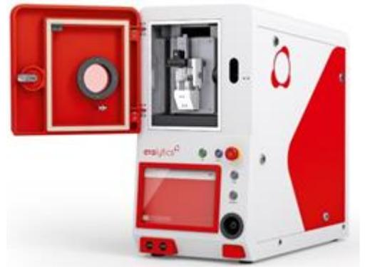
ERAOIL — это первый и самый совершенный автономный спектрометр с вращающимся дисковым электродом, анализирующий металлы износа, присадки и загрязняющие вещества во всех видах рабочих жидкостей, таких как смазочные масла, топливо, охлаждающие жидкости, техническая вода и т. д.
